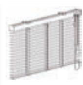
高性能ブラインド「パーフェクトシルキー」がさらに性能アップしました。昇降・回転を1本のボールで操作する従来の「ワンボール式」に操作がよりわかりやすい「ポール式」が加わり、さらに、より幅が狭い窓への対応が可能なサイズ展開となりました。
