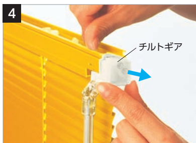
4 チルトギアをヘッドボックスから引き出します。その時ヘッドボックスの上部を指で広げざみにすると引き出しが楽です。
