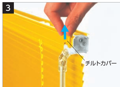
3 チルトカバーを上へ引き上げて外します。
