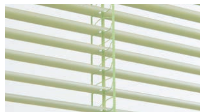
スラットの上下をはさみ込んだ、ダブルピッチの「ラダーコード」。水滴によるスラットどうしのくっつきを防ぎ、風によるバタつきも抑えます。
