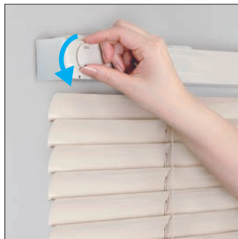
③ 丸いカバーの側面にある突起に指をかけ、矢印方向へ45度回転させ、カバーを取外します。
