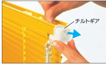
③チルトギアをヘッドボックスから引き出します。その時ヘッドボックスの上部を指で広げぎみにすると楽に引き出せます。
